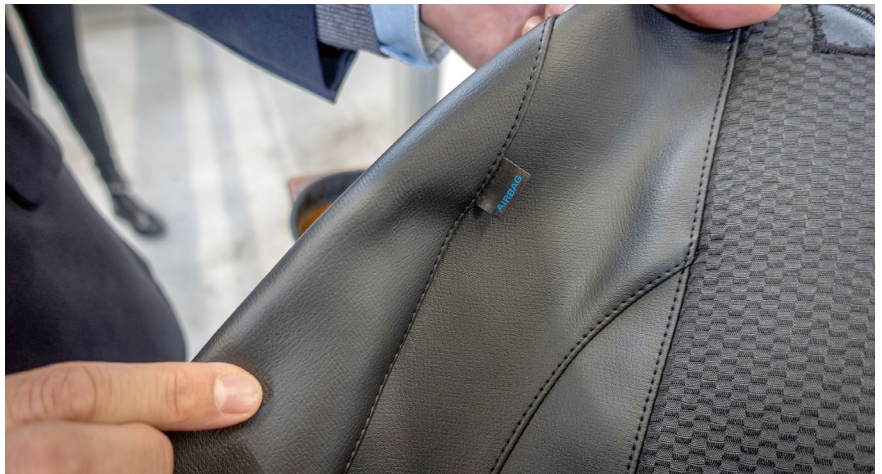
Die „Airbag-Naht“ ist ein neuralgischer Punkt bei den Passformbezügen.
